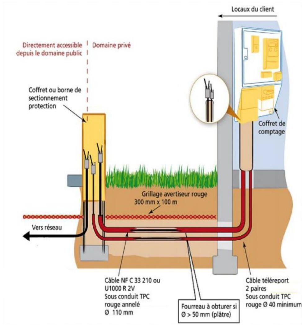
Le parcours des fourreaux et des câbles est le plus rectiligne possible en limitant les angles. Des chambres de tirage sont installées pour des longueurs supérieures à 50 m. La liaison est constituée de 2 câbles, un câble de puissance et un câble de téléreport. **Ces câbles sont posés respectivement dans un fourreau TPC de diamètre minimal de 110 mm et de 40 mm, à une profondeur de 80cm.**
